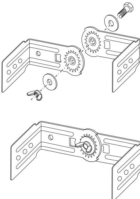
2. Nosače sa šrafovima učvrstite na držač za montažu na zid. Držači se mogu proizvoljno nameštati. Preporučuje se međusobna udaljenost od 45 do 55 cm.
